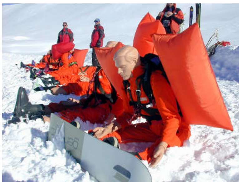
Fig. 2 : Test Dummy with Double Airbag. Major experiment at Pische-Wäng, 16. März 2001
